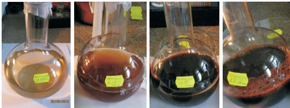
Рис. 4. Водная суспензия магнитоактивного нанокомпозита (слева направо — 0,001; 0,01; 0,1; 1,0 %)
